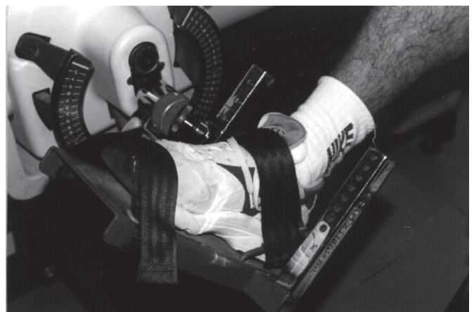
Fig. 7 – Alinhamento do eixo de movimento da articulação talocrural com o eixo de rotação do dinamômetro
